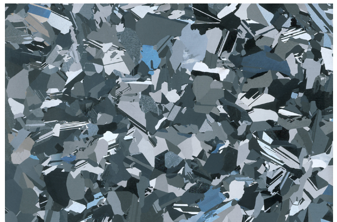
ABBILDUNG 260: Struktur von polykristallinem Silizium - BILD: Armin Kübelbeck
