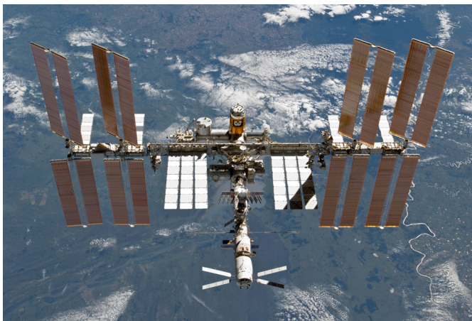
ABBILDUNG 251: Raumstation ISS, 120 kW aus 4.500m 2 Solarzellenfläche BILD: NASA
