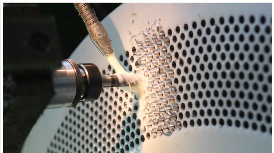
Ersatz- und Verschleißteile wie Koller und Matrizen werden ebenfalls aus eigener Hand gefertigt.
