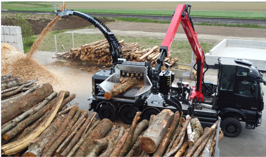
Der WT 11 XL NMV – aufgebaut auf einem 630 PS Mercedes Arocs Fahrgestell – erreicht eine Hackleistung von etwa 280 m 3 in der Stunde.
