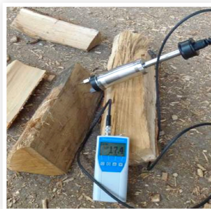
© LK Steiermark Messung des Wassergehalts von Stückholz
