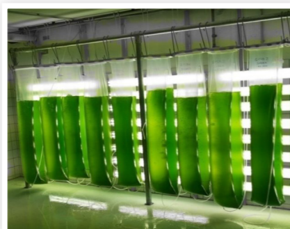
Schlauch-Photobioreaktoren zur Produktion von Mikroorganismen
