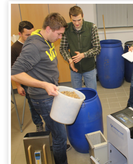
Mit neu entwickelten Geräten lässt sich der Wassergehalt von Proben rasch bestimmen.
