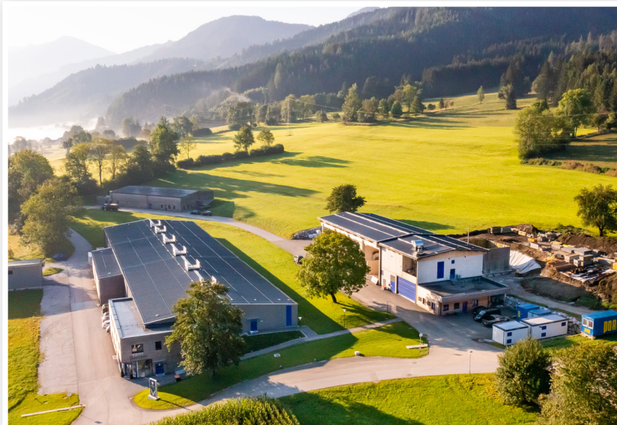
Garnelenzucht im Grünen: Im Gebäude links schwimmen die Garnelen in getrennten Wasserbecken, welche die Wärme des Holzgaskraftwerks (Gebäude rechts mit Hackschnitzlager) konstant auf 28 °C hält.
