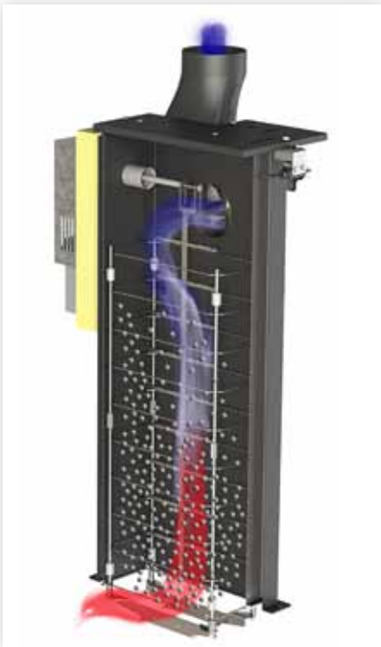
Abb. 3: Abscheideprinzip eines integrierten E-Filters
