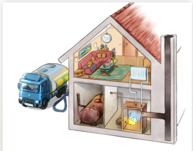
Schema eines Hauses mit Ölheizung und Öltank, ca. 20 m 2 Flächenbedarf für Lager und Heizraum.
