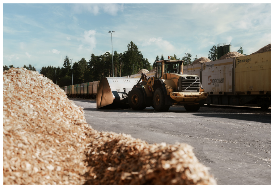
Für Hackgut gibt es oben offene Container, die direkt am Gleis per Bagger beladen werden – ein Zug aus 24 Waggons mit je drei Containern kann mit ca. 2.600 bis 2.800 srm Hackgut beladen werden.
