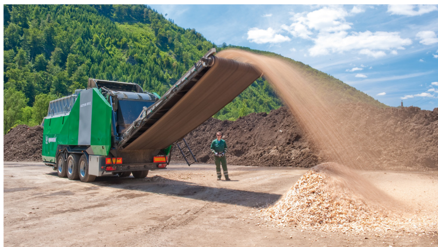
Das Hacken von Energieholz am zentralen Lagerplatz ist eine von vielen Optionen der Biomasselogistik.
