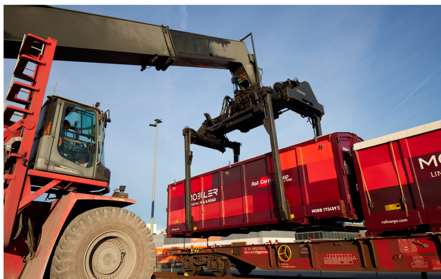
Eine hydraulische Hubvorrichtung am MOBILER ermöglicht einen raschen und unkomplizierten Umschlag von Containern sowie Wechselbrücken zwischen Lkw und Waggon ohne Kranarbeiten.
