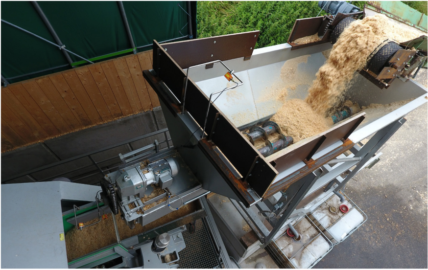
Bei der Hackschnitzelquetsche erfolgt die Trocknung mechanisch in einer Walzenpresse.
