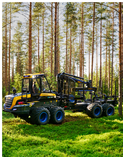
Rückezug mit 15 Tonnen Tragfähigkeit und einem vollständig elektrischen Antriebsstrang.
