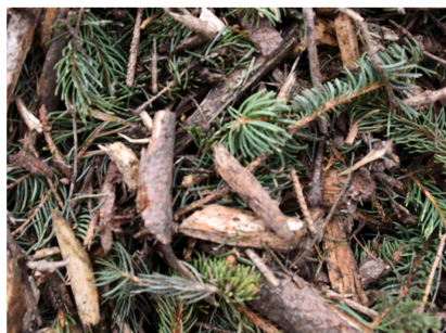
Hohe Feinanteile bedingen eine geringe Qualität von Hackschnitzeln aus Waldrestholz.
