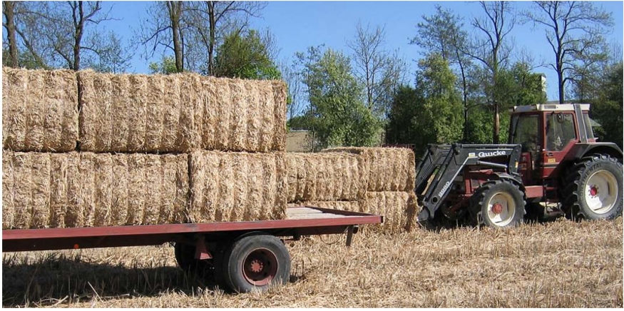
Großquaderballenlogistik mit Frontlader und Plateauanhänger, wie sie für die Verfahren zwei bis vier verwendet wird
