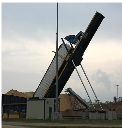
So kann das Entladen eines Hackschnitzel-Transporters in den USA aussehen.
