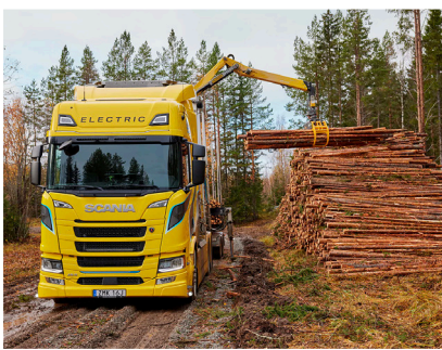
Elektrische Holzabfuhr in Schweden, die Reichweite des 450 kW-E-Motors beträgt etwa 200 km.
