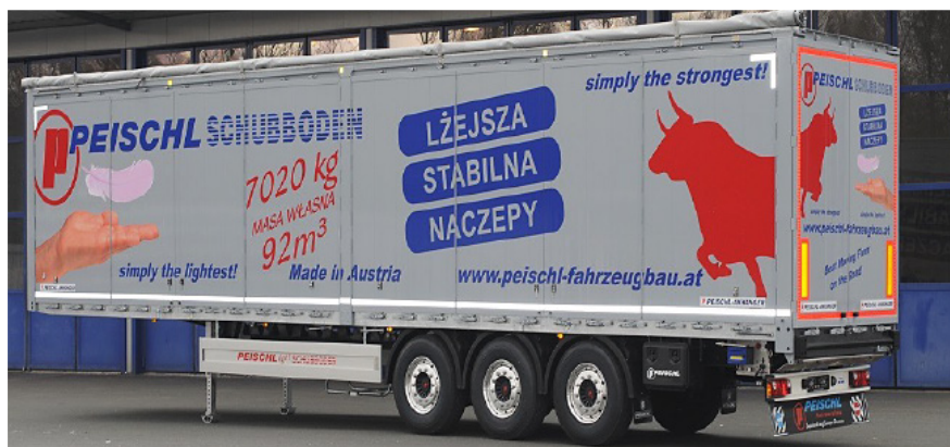
Für den Transport zum Heizwerk werden großvolumige Schubbodensättel mit einem Fassungsvermögen von 92 m 3 und einem Eigengewicht von etwa 7 Tonnen benötigt.
