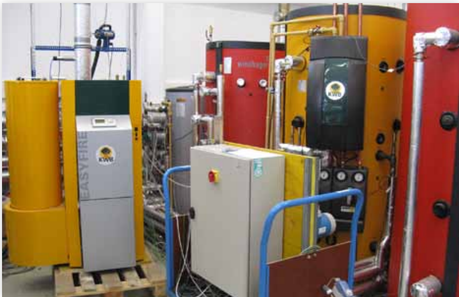
Experimenteller Aufbau zur Ermittlung von Jahresnutzungsgraden am Versuchsstand für verschiedene Heizungs-konfigurationen
