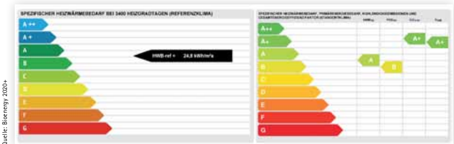
Abb. 1: Vergleich der Energieskalen im Energieausweis „alt“ und „neu“ – bei Letzterem sind zusätzlich zum Heizwärmebedarf Primärenergiebedarf (PEB), Kohlendioxidemissionen (CO 2 ) und Gesamteffizienzfaktor (fGEE) angegeben.
