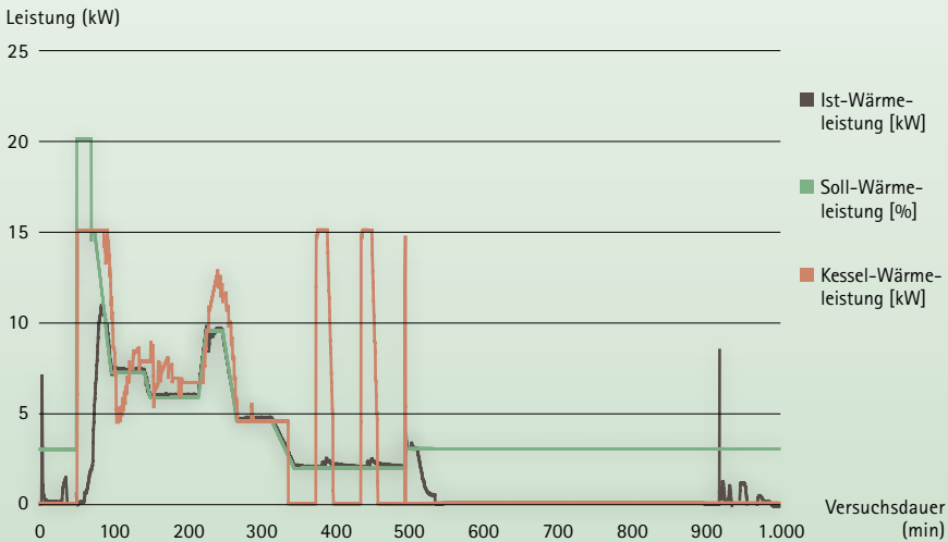
Abb. 5 und 6: Leistungsregelungsverhalten und Emissionen eines modernen, gut modulierbaren Pelletskessels
