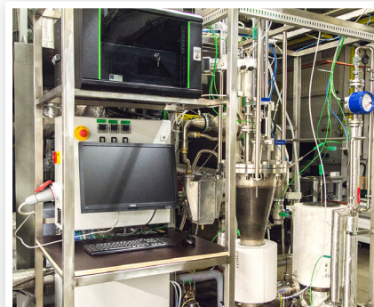
Laboranlage zur Bewertung neuer Materialien mit digitaler Schnittstelle (li.), Zweibett-Wirbelschicht (Mitte) und Gasvorwärmer (re.)
