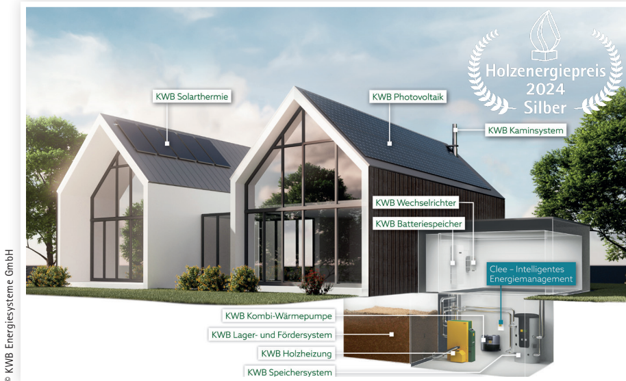
Das Energiemanagementsystem Clee stimmt verschiedene erneuerbare Energiesysteme wie Holzheizung, Sonnenenergie und Umgebungswärme optimal aufeinander ab und senkt so die Energiekosten.
