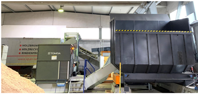
Ein Röntgengerät reinigt das Recyclingholz von Nichtholzbestandteilen, wie Metallen, Steinen, Keramik, Ziegeln oder Kunststoffen, und sortiert diese aus. Mit dem eigenen Fuhrpark aus 19 Spezialfahrzeugen werden die Pellets in Tanks zu den Endkunden transportiert.
