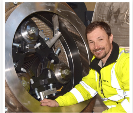
Die Pelletspresse fertigt qualitativ hochwertige ENplus® A1 Pellets.
