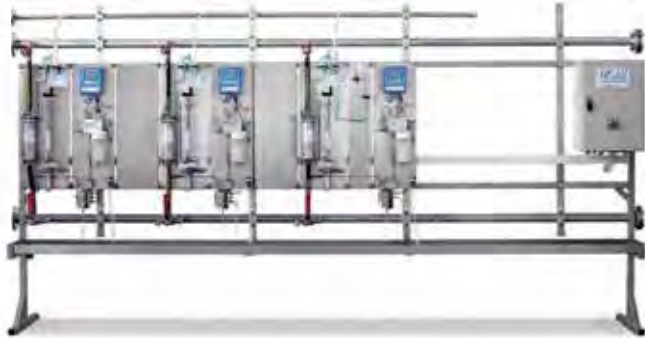
Probenahmestation inklusive Probenkonditionierung (Probenkühlung, Druckreduktion, Temperatursicherheitsventil, Rückdruckregler, Handprobe, opt. Schaltschrank, Kommunikation...)
