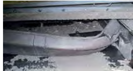
Verbogene Stahlmitnehmer in einem Kratzkettenförderer für Brennstoffzufuhr, verursacht durch einen Fremdkörper
