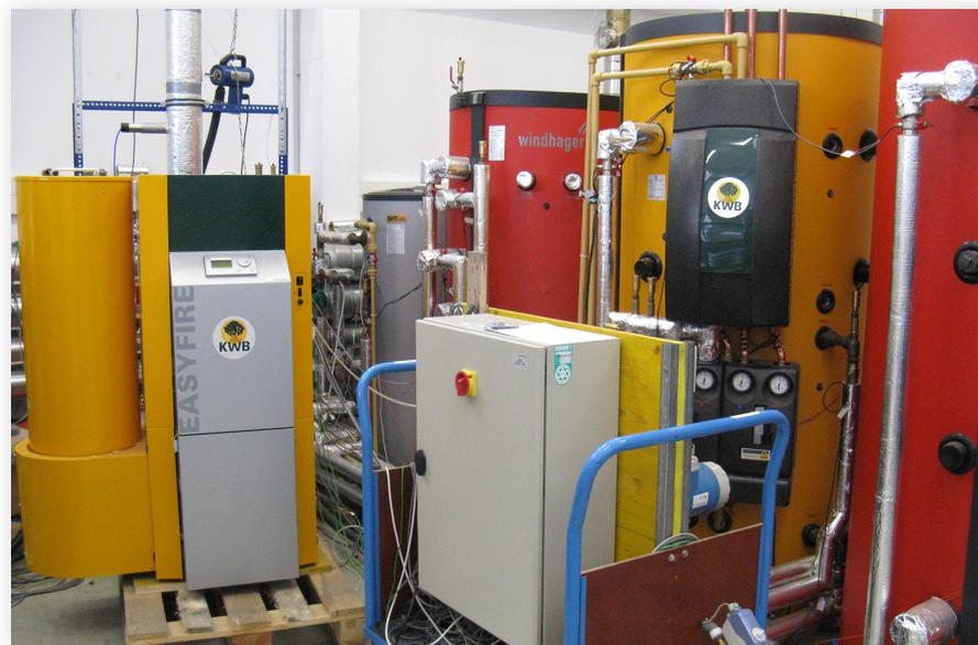
Experimenteller Aufbau zur Ermittlung von Jahresnutzungsgraden am Versuchsstand für verschiedene Heizungskonfigurationen
