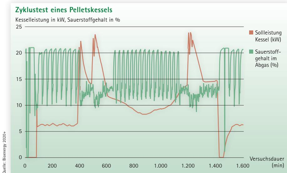
Abb. 3: Pelletskessel mit mangelnder Teillast- und Modulationsfähigkeit
