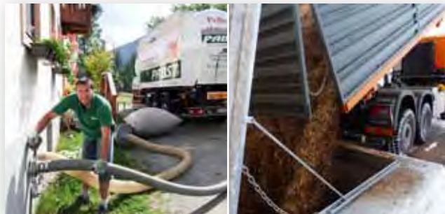
Brennstoffbelieferung bei Pellets (li.) und bei Hackschnitzeln
