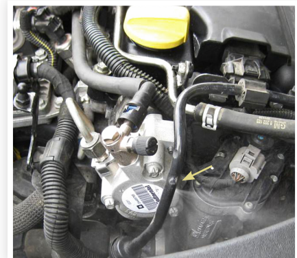
Nach 27.600 Kilometern mit dem Kraftstoff E10 trat im Betrieb bei etwa 120 bar ein feiner Kraftstoffstrahl am Pumpengehäuse aus – das Fahrzeug war vom Hersteller nicht für E10 freigegeben.
