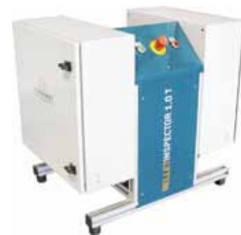
Der Pelletinspector 1.0 T bestimmt die mechanische Festigkeit von Holzpellets.
