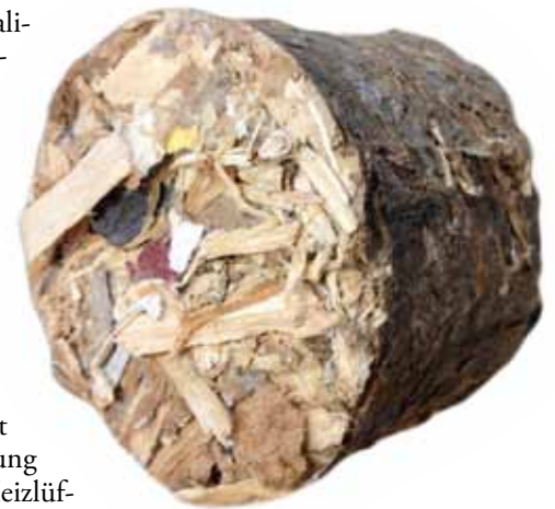
Aus Abfällen werden Briketts hergestellt.
