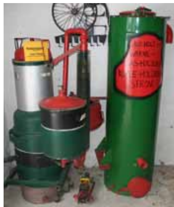
Malzer-Erfindung: Holzvergaser „Gigantus“
