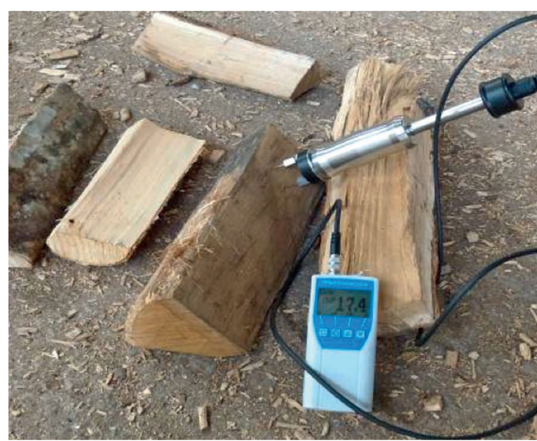
Messung des Wassergehalts von Stückholz
