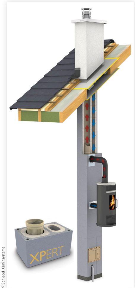
Abb. 8: Ein für die Niedrigenergiebauweise zertifiziertes Kaminsystem
