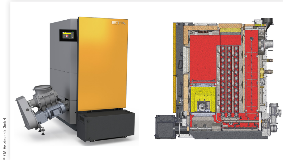
Abb. 2: Darstellung der Einbausituation und des kombinierten Reinigungs- und Entaschkungskonzepts am Beispiel des Hackgutkessels ETA eHACK
