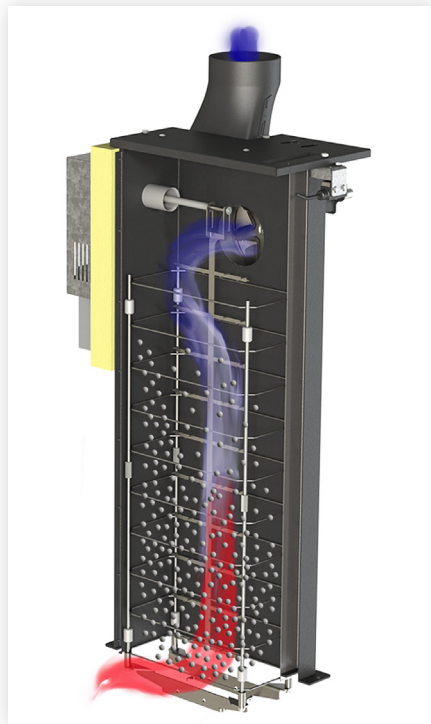
Abb. 3: Abscheideprinzip eines integrierten E-Filters
